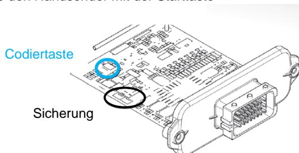
Position des Codiertasters und der Sicherung (Empfänger)
