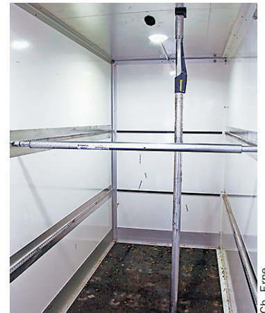
Stangen fixieren das Ladegut.
