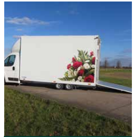
Der Kastenaufbau mit tiefer Rampe ist Basis für die Branchenlösungen.
